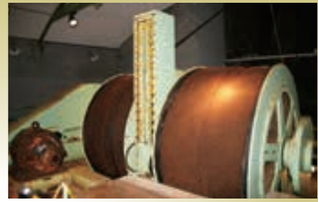
光栄立坑 巻揚機
